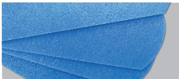
発泡倍率約8倍のポリプロピレン製シートです。永久帯電防止機能を追加し、高い緩衝性・優れた加工性を持つ高性能製品です。用途によって使い分けることができます。
