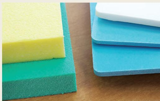
発泡とは、ある物質を高温状態でガスなどを混ぜることによって、物質自体の体積を増やす加工方法です。発泡PPシートは、ポリプロピレン（PP）を板状に発泡させたものです。プラダン中空構造ですが、発泡PPシートは目が詰まっているのが特徴です。（同様の発泡構造をもつポリエチレンシートも取り扱っています）
