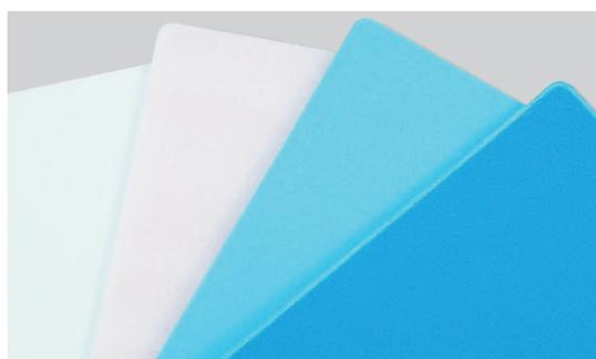
平滑な表面層と微小独立泡からなる発泡倍率1.3～3倍のポリプロピレン製シートです。中空構造のプラダンでは対応しにくい食品や医薬品、クリーンルームなど異物やゴミの進入を嫌う用途に適した製品です。
