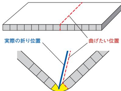
プラダンの筋目の上に折り目線が入ると折り目は左右どちらかの中空部分へ±5mm程度ずれて曲がります。不都合がおきないように寸法差を考慮した設計でケースを製作していますが、若干の誤差はご了承ください。
